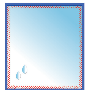
Reduzierter Wärmeverlust durch die warme Randzone. Vermeidung von Kondensat.
